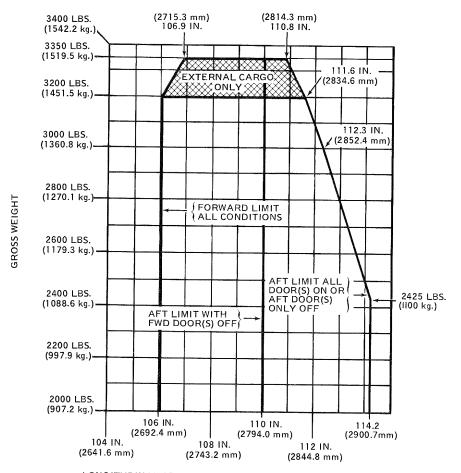
LONGITUDINAL CENTER OF GRAVITY — FUSELAGE STATIONS
